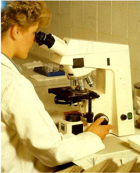
5) cambiare obbiettivo (medio 20 X o grande 40 X) mettendo a fuoco solamente con la vite micrometrica; 6) ruotando la vite del condensatore si può aumentare la luminosità o il contrasto dell'immagine; 7) accertarsi che la fonte luminosa sia nella giusta posizione (e non sia ruotata lateralmente). *N.B. L'ingrandimento totale si calcola moltiplicando il valore dell'ingrandimento scritto sull'oculare per quello scritto sull'obbiettivo.*
