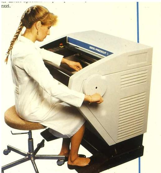
Il pezzo appena prelevato viene fissato per immersione in azoto liquido o con un getto di CO2 compressa che lo raffredda molto rapidamente, senza farlo cristallizzare, quindi viene tagliato al criostato. Le sezioni così ottenute sono pronte per le colorazioni sia istologiche che istochimiche.
